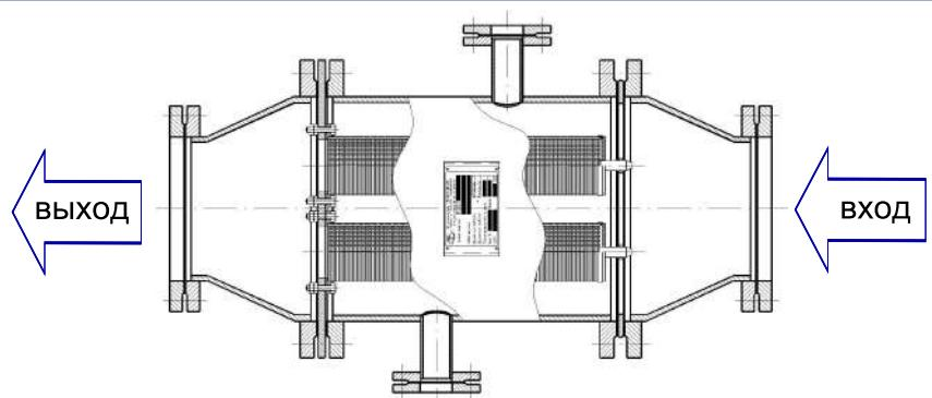
Принцип действия фильтра-ловушки заключается в том, что вода после фильтров под давлением поступает в переднюю его часть, проходит через фильтрующие элементы и отводится из фильтра-ловушки. Фильтрующий материал (ионообменная смола, песок, уголь или др.) задерживается на фильтроэлементе, промывка которого впоследствии производится обратным током воды.
