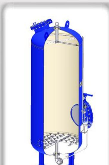
Фильтр ионитный параллельноточный (ФИПа)
