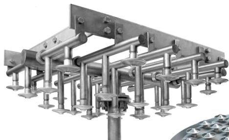
Внутренние устройства фильтров
