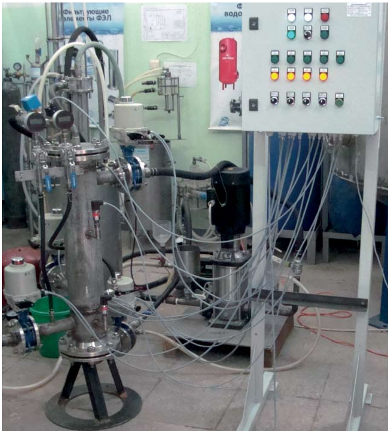
Рис. 5. Действующий макет фильтра со шкафом управления.
