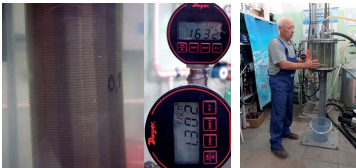
Рис. 3. Ход испытаний ФЭЛ без перекрытия рабочей поверхности.
