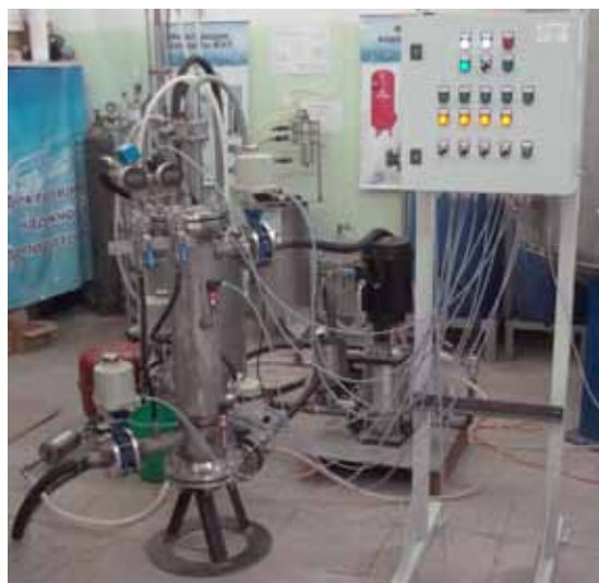
Рисунок 2 Испытания фильтра ФМО с автоматическим блоком управления в аккредитованной лаборатории «ТЭКО-ФИЛЬТР».
