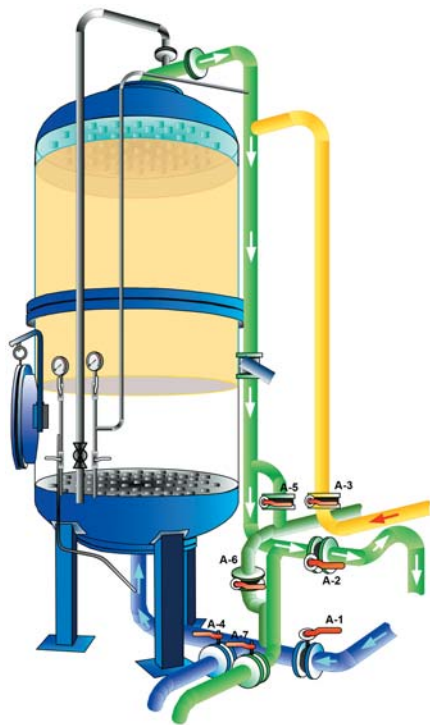
Рис. 7. Фильтр с зажатым слоем
