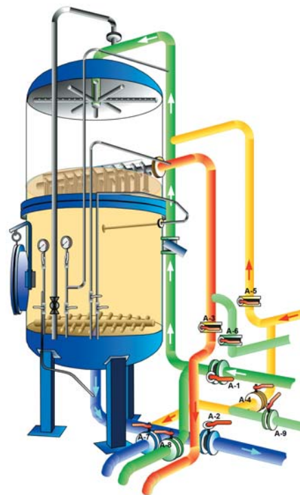
Рис. 6. Фильтр с гидравлическим зажатием слоев
